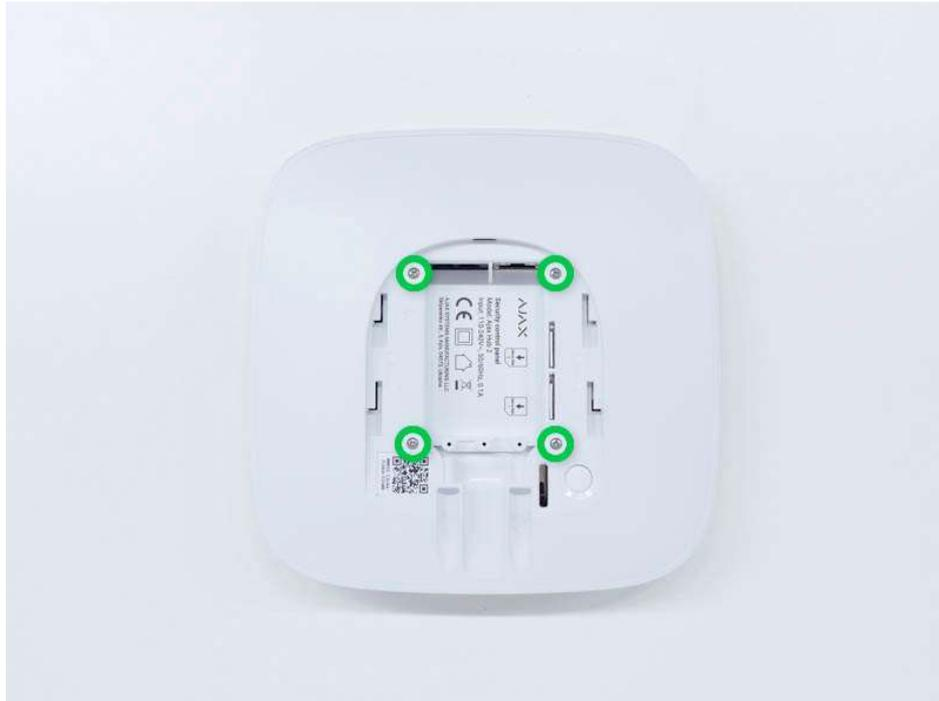
5. Retirez les vis qui fixent les cartes au boîtier de l'appareil.
