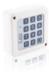
300TSG-4RP Clavier numérique radio à pile, à associer à un récepteur radio 433,92 MHz à auto-apprentissage ou à une centrale de commande avec récepteur radio compatible
