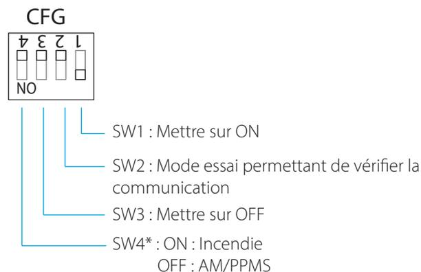
\*Mettre SW4 sur la position adaptée à votre utilisation suivant le paragraphe «COMPATIBILITÉ»
