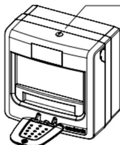
Trou d'accès au mode essai
