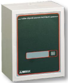
Permettent de déporter le raccordement des défauts techniques ou des commandes d'asservissements. Les boîtiers déportés sont reliés au consigneur à l'aide d'un bus de communication 2 paires 8/10ème ou 9/10ème.
