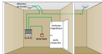
Conformément aux normes en vigueur, le DAD BC6 NF permet, par exemple, de commander la fermeture des portes CF de communication entre la surface de vente et les réserves de magasins.
