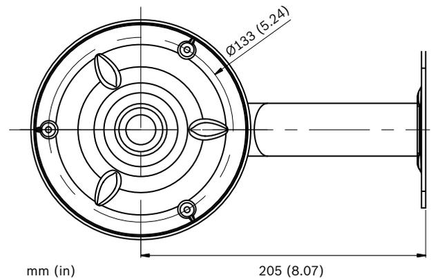
**VDA-PMT-DOME - Support de montage sur tube**
