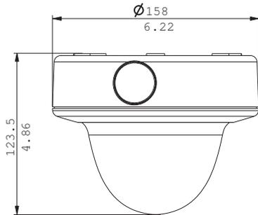
Dimensions en mm pour le modèle FlexiDome<sup>VF</sup> à faible résistance aux chocs, intérieur, montage en surface
