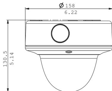
Dimensions en mm pour le modèle FlexiDome<sup>XT+</sup> à résistance élevée aux chocs, intérieur, montage en surface
