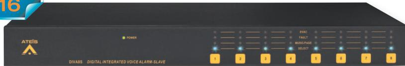
Le module DIVA8S-G2 Esclave est une extension du DIVA8M-G2 Maître. Il permet d'augmenter les capacités du système de 8 zones par module Esclave. Le nombre maximum d'esclaves pouvant être ajoutés au système DIVA8 est de 15. Un système complet DIVA8 (maître plus esclaves) peut atteindre 128 zones (A/B). Les modules esclaves sont liés au module maître via un câble CAT-5 (longueur max 100 m).
