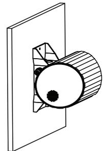
**1)** Déterminez la position de montage du haut-parleur. Placez le haut-parleur au mur ou au plafond et marquez à travers les trous de montage pour positionner les points de fixation. Utilisez un niveau à bulle pour vous assurer que le haut-parleur sera de niveau une fois fixé. Percez 2 trous séparés de 174 mm. Utilisez des bouchons bruts appropriés pour sécuriser les fixations.
